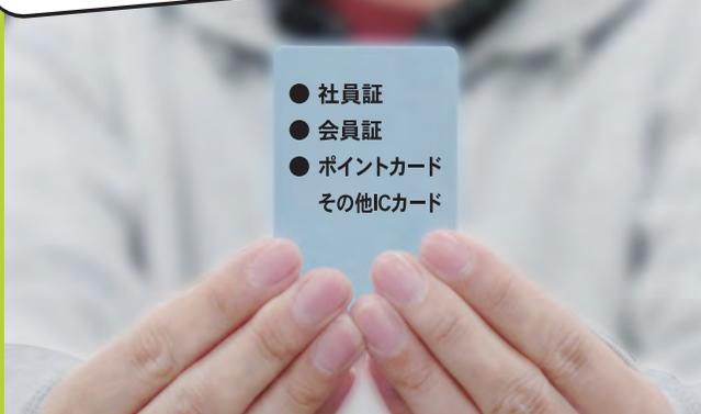
ピックルは付属のカードキー以外にMifare規格の非接触ICカードもカギとして使用する事ができます。Mifare規格のカードは、社員証やポイントカード等、世界中で多く使用されています。
